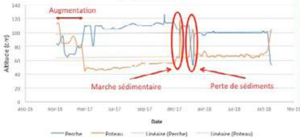
Variation de la hauteur des sédiments au niveau de l'enrochement
